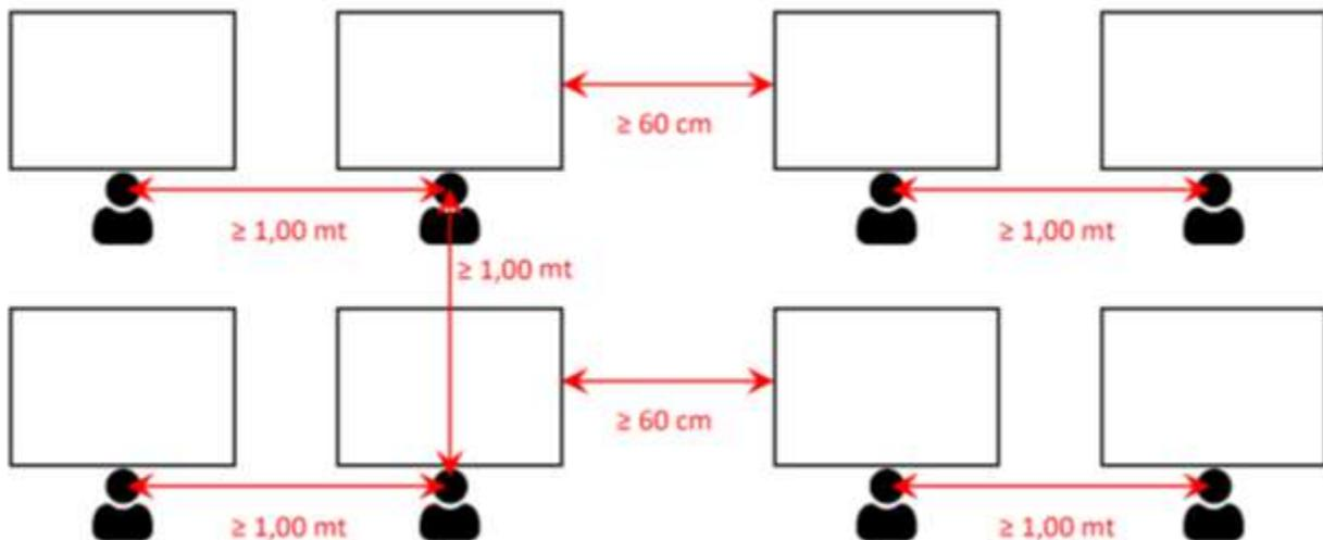
Tale disposizione prevede file di due banchi monoposto, opportunamente distanziate per garantire il metro minimo di distanza dalle rime buccali degli alunni seduti, intervallate da un "corridoio", vale a dire uno spazio più ampio che sia nel suo minimo di 60 centimetri, in grado di garantire un'adeguata via di fuga per la gestione delle emergenze.
