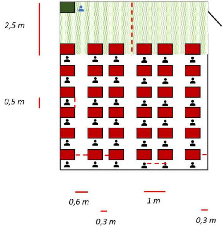
Al fine di agevolare il corretto posizionamento dei banchi degli alunni, sono individuate mediante idonei "marker" sul pavimento, le posizioni dei piedini che consentono un semplice riposizionamento nel giusto distanziamento a seguito di movimenti involontari.
